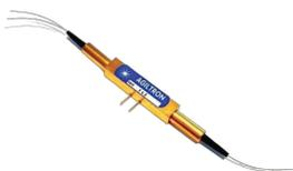
Nous proposons une large sélection d'atténuateurs optiques variables pour la plupart des scénarii d'application. Ces atténuateurs pilotables électriquement à distance et permettent de réduire la puissance optique reçue par un détecteur photoélectrique avec une gamme d'atténuation de 0 – 15 dB ou 0 – 30 dB, de faibles pertes d'insertion, aux longueurs d'onde 1310, 1550, ou 1310/1550 nm.
