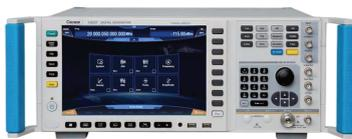
Comparé au modèle précédent, ce générateur opère sur une gamme de fréquences de 100kHz à 67GHz, avec un bruit de phase SSB de -126dB/Hz (pour une porteuse à 1GHz et un offset de 10kHz), une grande puissance de sortie jusqu'à 1W, une large dynamique de plus de 150dB.
