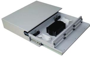
Les tiroirs optiques permettent le raccordement de câbles pour en assurer la distribution vers d'autres câbles ou matériels actifs. Installés dans des baies ou des répartiteurs, les tiroirs optiques peuvent être équipés de raccords, de pigtaills, de zones de lovage et de cassettes d'épissurage.
