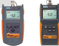
La série AYFHS2 offre en plus l'opportunité de fonctionner en tandem avec un photomètre (voir p.8) : en plus de la longueur d'onde, un protocole d'identification est transmis au photomètre avec les paramètres de calibration.
